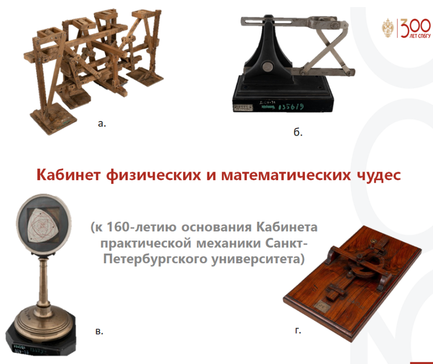
Рис. 1. Экспонаты выставки. (а.) Стопоходящая машина П. Л. Чебышева. Черновая модель первой в мире шагающей машины, экспонировавшейся на Всемирной выставке в Париже в 1878 году. (б.) Механизм Чебышева. (в.) Выпуклый трехсторонник в квадрате (треугольник Рело). (г.) Сердцевидный эксцентрик
